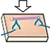
يصنع من النحاس وينقل الكهرباء. تغطي الاسلاك بالبلاستيك لأنه يشكل طبقة عازلة للحماية.
