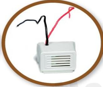
يحتاج هذا الطنان الكهربائي إلى جهد كهربائي (3V) ليعمل.
